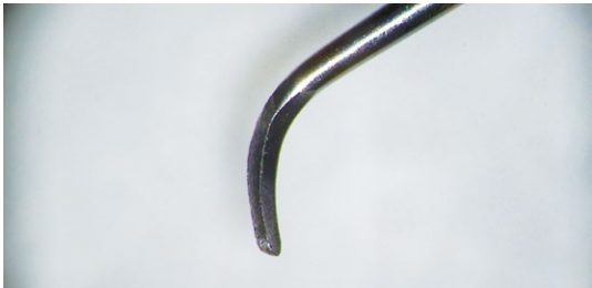
Afb. 5 Na het slijpen zie je meteen dat het werkblad weer scherp is.
