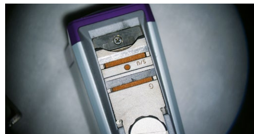
Afb. 13-14 De korrelgrootte van een Sidekick van Hu Friedy is veel grover dan die van een arkansassteentje. Je kunt met dit steentje dus veel scherper slijpen.
