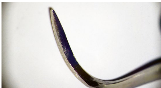
Afb. 15-16 Deze H6/H7-scaler heeft een behoorlijke deuk, maar is nog wel te redden met een slijpbeurt onder de microscop .
