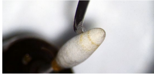
Afb. 3-4 Het arkansassteentje is met de microscoop exact tegen het werkblad te plaatsen.
