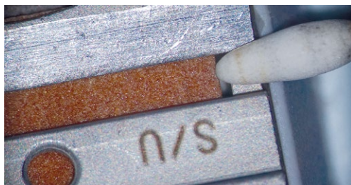
Afb. 13-14 De korrelgrootte van een Sidekick van Hu Friedy is veel grover dan die van een arkansassteentje. Je kunt met dit steentje dus veel scherper slijpen.
