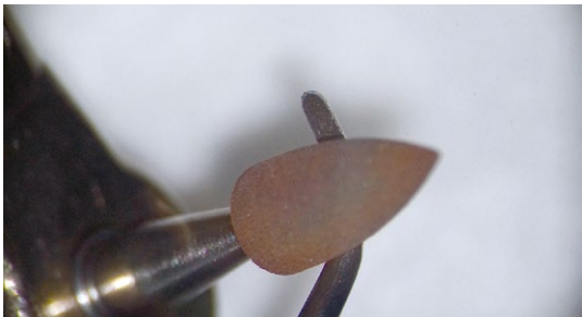
Afb. 8-9 Na afloop van het slijpen worden de geslepen instrumenten nog even gepolijst met een brownie. Dat maakt ze gladder en dus beter reinigbaar, maar houdt je instrumenten ook langer scherp.
