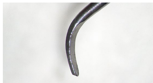
Afb. 1-2 Een ietwat botte curette. Dankzij de sterke vergroting is te zien dat de snijkant best is afgerond en dat verklaart waarom de curette niet meer scherp voelt.
