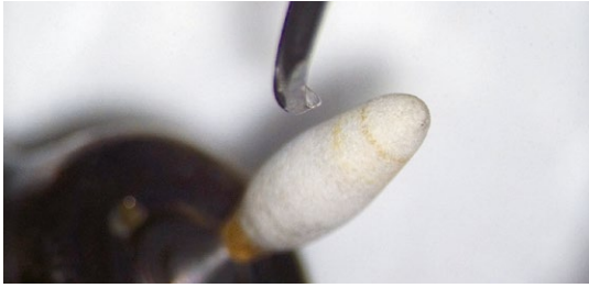
Afb. 3-4 Het arkansassteentje is met de microscoop exact tegen het werkblad te plaatsen.
