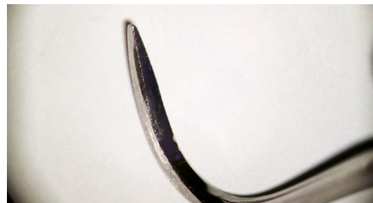
Afb. 15-16 Deze H6/H7-scaler heeft een behoorlijke deuk, maar is nog wel te redden met een slijpbeurt onder de microscop .
