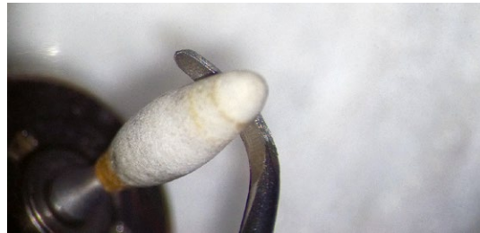
Afb. 6 Ook de bovenkant van het werkblad moet worden meegenomen, want daarmee maak je een mooie scherpe hoek.
